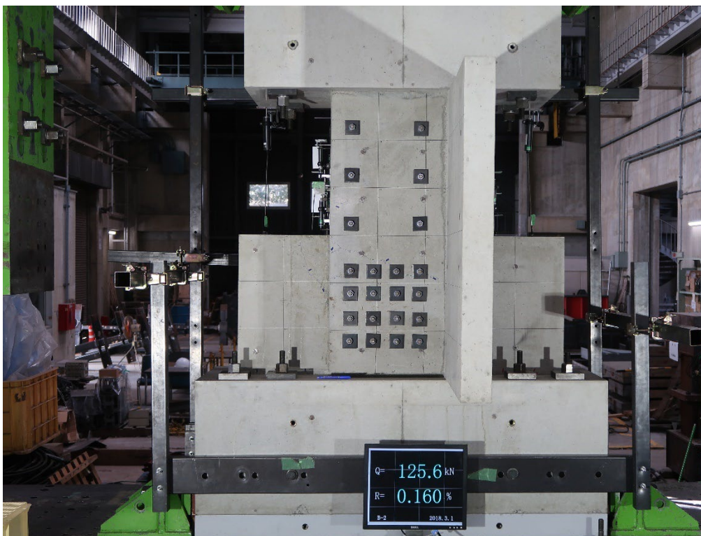
付写真 1.2.4-35 B-2 全景写真(R=+1/400①)
