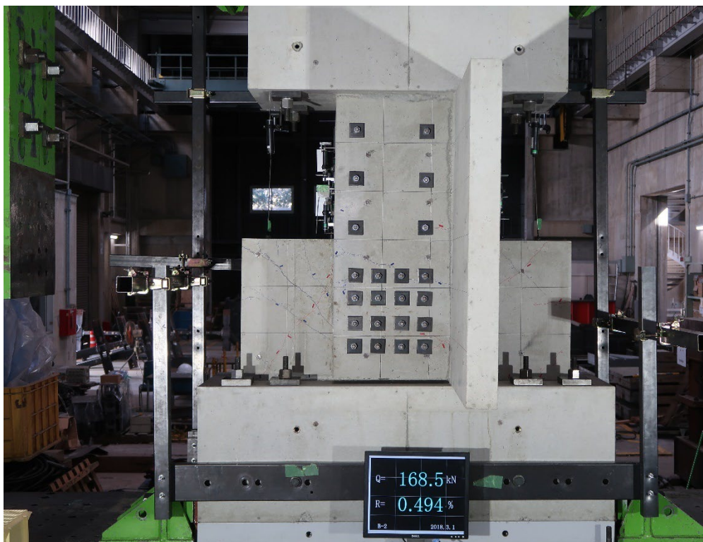
付写真 1.2.4-43 B-2 全景写真(R=+1/133①)
