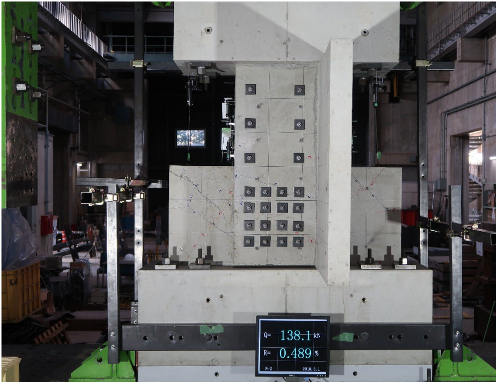
付写真 1.2.4-45 B-2 全景写真(R=+1/133②)
