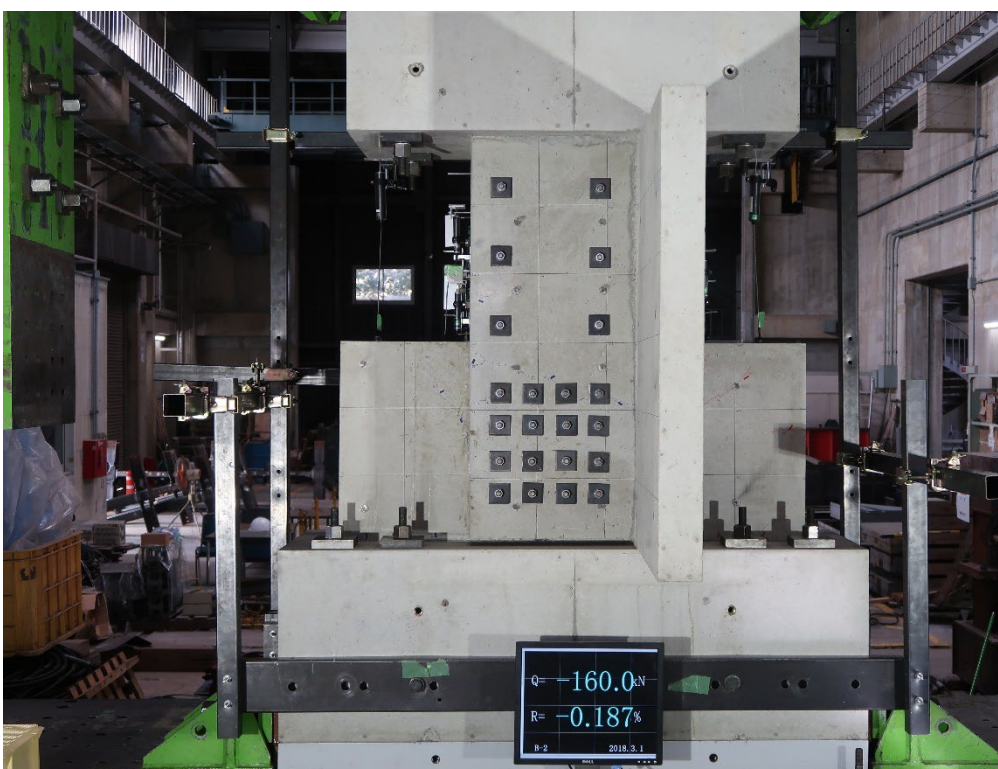
付写真 1.2.4-38 B-2 全景写真(R=-1/400②)
