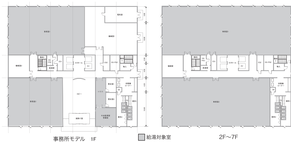
図 2.1-7 給湯設備の計算対象室（1階、2～7階）
