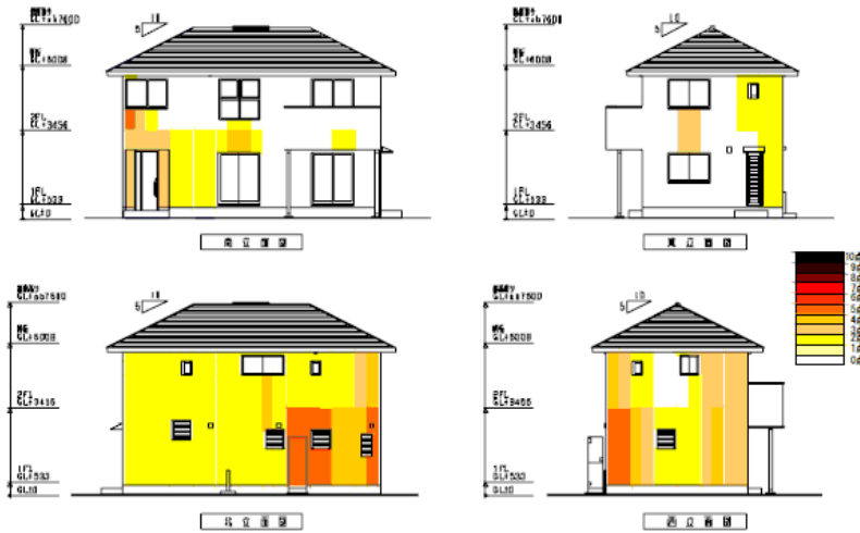
LOOP「Revo みえる図」(外壁劣化部位の推定)
