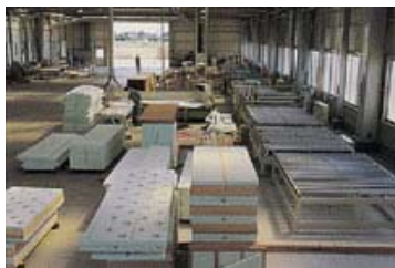
【専用ラインでの工場生産】 現場作業では難しい施工精度と品質管理を実現。
