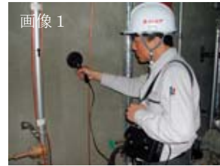
住宅診断：基礎配筋検査の例
