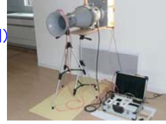
気密性能試験の例
