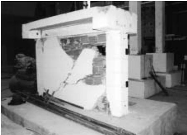
写真 プロジェクトで最初の構造実験（柱梁が鉄筋コンクリート造でその枠内に「ツーラ」と呼ばれる穴あきレンガの壁を設けたトルコで典型的な構造）
