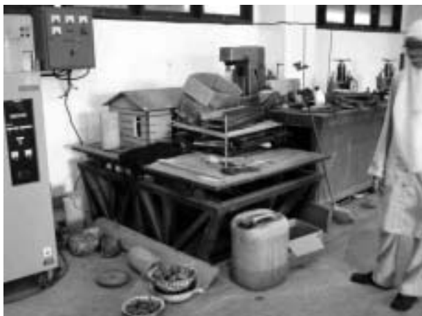
写真一34 ネパールの NGO NSET から供与されたデモンストレーション用の簡易振動台
