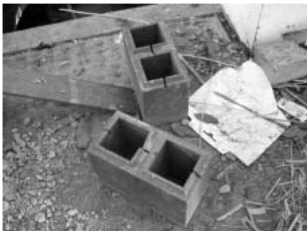
写真一31 シャクワラ大学で開発中の壁用のコンクリートブロック
