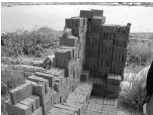
写真一28 雨で溶けているレンガ
