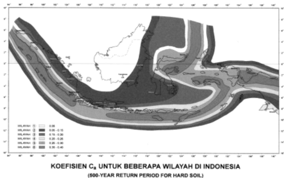
図ー2 インドネシア建築基準の地震地域分類図 ニアス島、スマトラ島西海岸などが最も リスクが高い地域6 ( 0.30g \sim 0.40g )、 バンダアチェ周辺はそれに次ぐ地域5 ( 0.25 \sim 0.30g ) に区分されていること がわかる。
