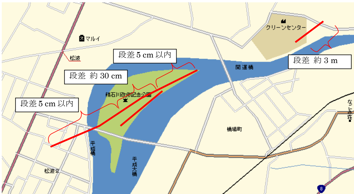
図 5.3 柏崎市松波で確認したひび割れの位置
