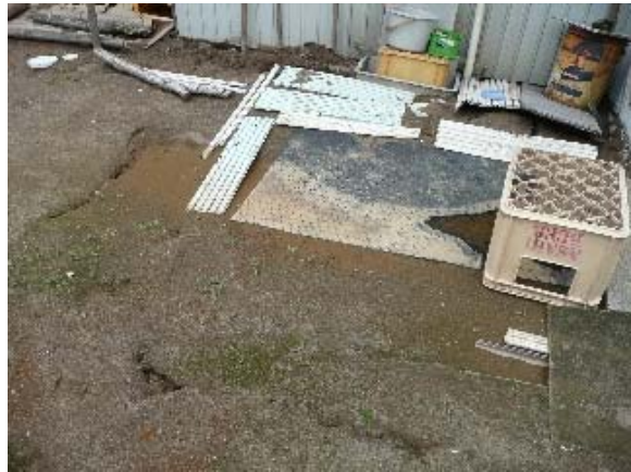
写真 5.26 写真 5.23 の敷地の噴砂痕
