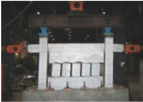
写真1 韌性壁の水平加力実験
