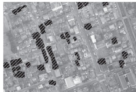
図 1 瓦礫判読結果 (赤線部分が瓦礫流出図形)
