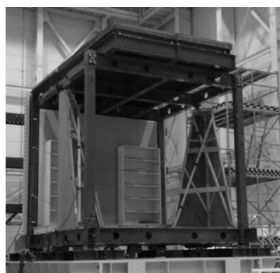
図 2 実大振動台実験外観
