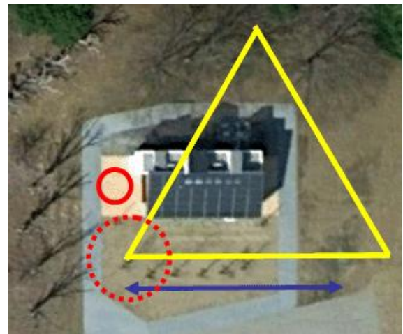
図1 微動観測アレイの大きさの例：(建研構内(LCCM実験住宅)：円(CCA法、半径2m)、点円(CCA法、半径5m)、三角(SPAC法、一辺30m)。
