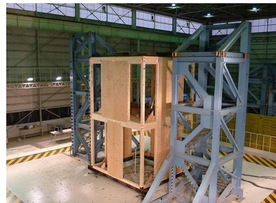
図 4 振動台実験試験体
