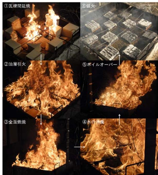
図 2 津波火災の燃焼性状に関する実験<sup>6)</sup>
