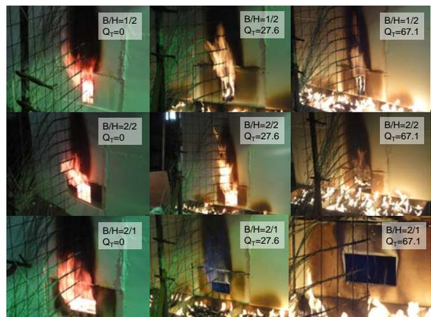
図 3 津波避難ビルの上階延焼危険性に関する実験<sup>7)</sup>
