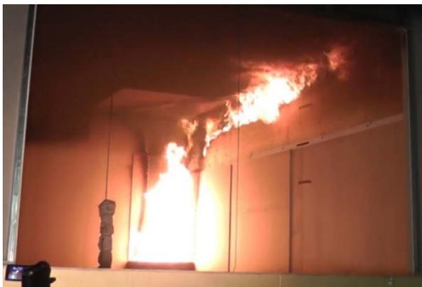
図 3 天井を不燃化した木質内装における煙層の予熱による火炎伝播条件の定量化実験
