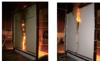
図3 アルミ製間仕切り壁の加熱実験
