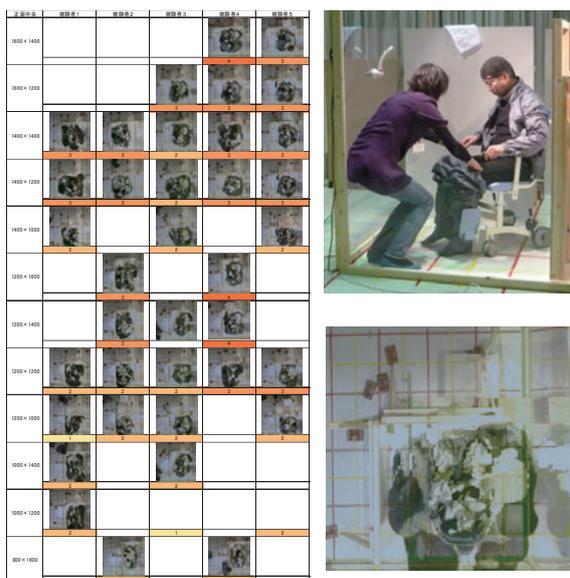
図3 浴室寸法と介護浴のしやすさの評価
