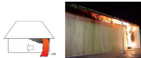
図 5 木材をはった外壁の水平火炎伝搬実験
