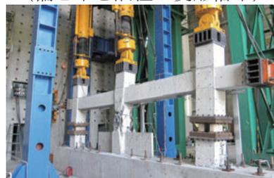
図3 RC構造の実験の一例 (せん断破壊後の軸力支持能力確認実験)
