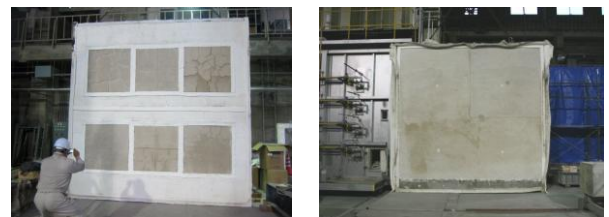
(a)小型壁による実験 (b)大型壁による実験 写真1 小型壁による防耐火性評価の実験例
