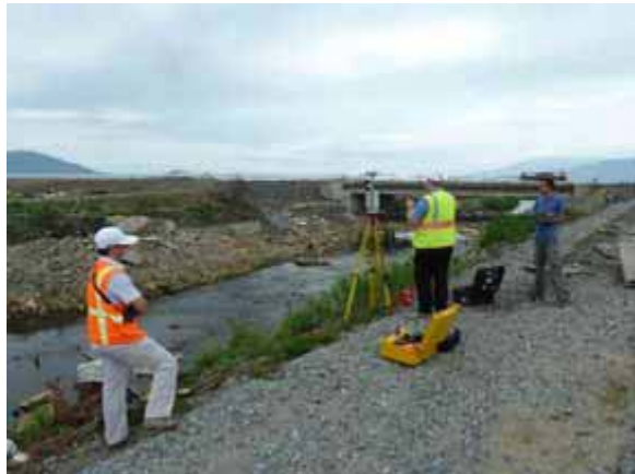
写真－1. 4. 1. 2 LiDAR (light detection and ranging, 光検出と距離計測) 装置を使った地形の 3 次元計測 (陸前高田市)
