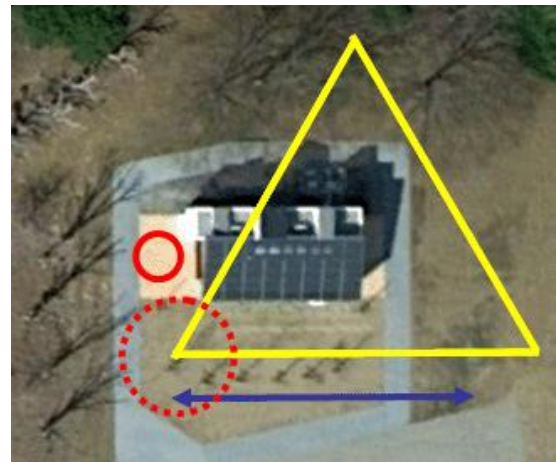
図1. 微動観測アレイの大きさの例：(建研構内(LCCM 実験住宅)：青線(長さ 25m)、赤円(CCA 法、半径 2m)、赤点円(CCA 法、半径 5m)、黄色三角(SPAC 法、一辺 30m)。
