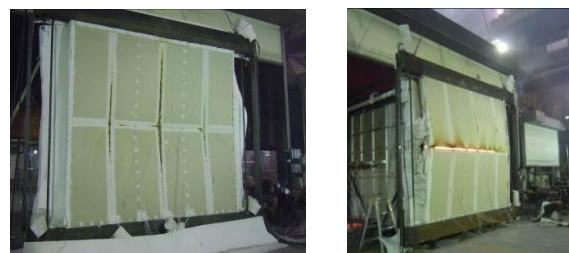
a) S2 (熱応力) b) S4 (強制変形) 図4 試験体の損傷状況
