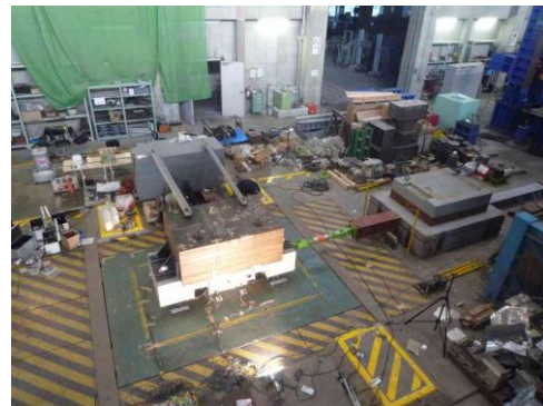
図 5 基礎すべり震動台実験
