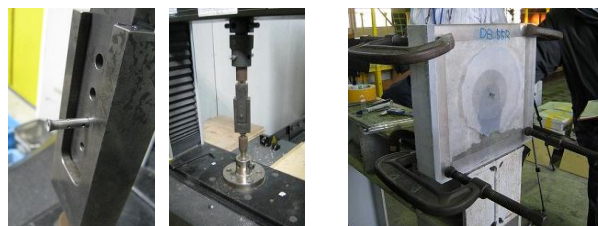
(a)ピン単体せん断試験 (b)樹脂拡散確認実験 写真2 注入口付きアンカーピンの試験の状況
