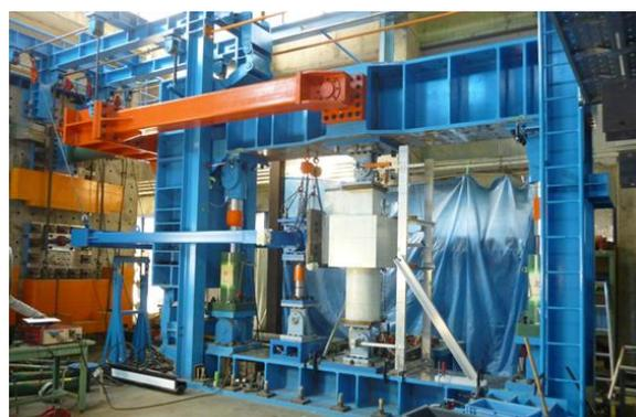
写真 1 杭頭接合部の部分架構実験
