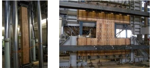
図1 座屈試験 (左) と面内せん断試験 (右) の様子
