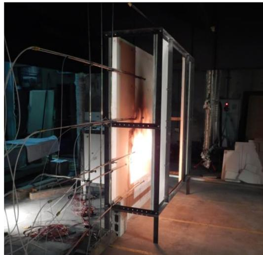
図2 ダブルスキンにおける噴出火災性状に関する模型実験
