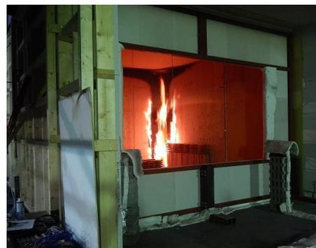
図7 天井不燃化によりフラッシュオーバーの遅延効果を確認する火災実験
