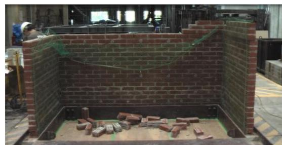
写真1 金網補強の試験体(実験終了後)
