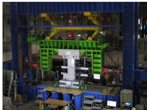
図 3 壁試験体の加力装置
