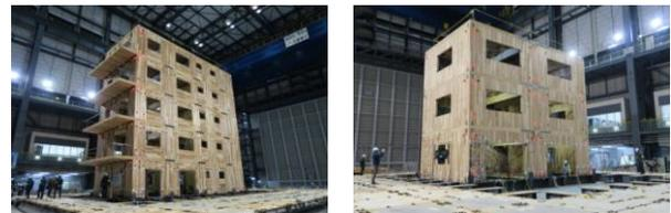
図3 実大加振試験の様子
