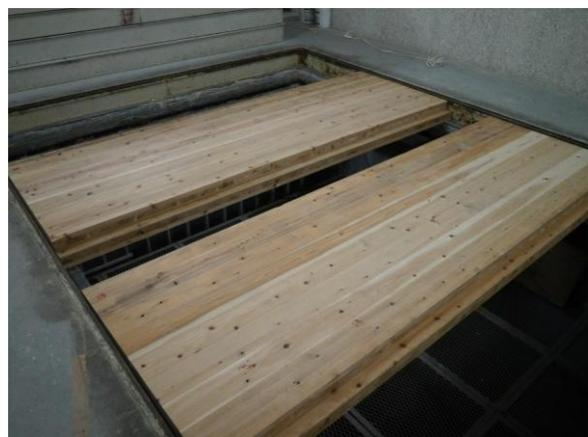
写真 1 CLT パネルの駆動点インピーダンスの測定状況
