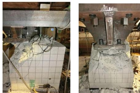
図 2 側方破壊した接合部
