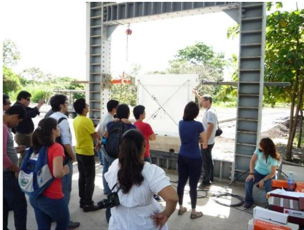
写真一1. 5. 1. 2 コンクリートブロックを用いた枠組組積造壁試験体の加力準備 (UES 実験棟)
