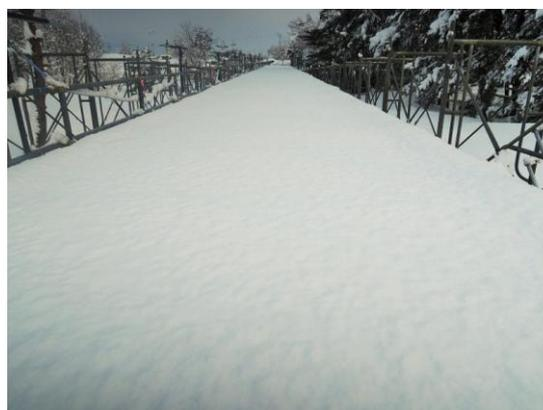
写真 1 流れ方向長さ 50m の試験体の概観と屋根上の積雪状況
