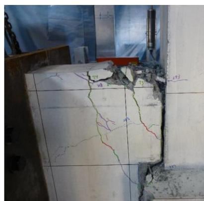
写真 2 基礎梁端部の降伏
