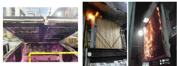
図4 炭化速度測定試験 (左) と壁の荷重加熱試験 (右) の様子
