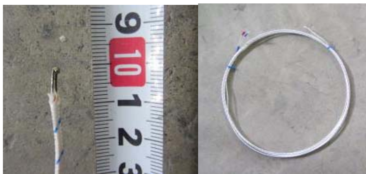
写真 1 熱節点の処理状況
