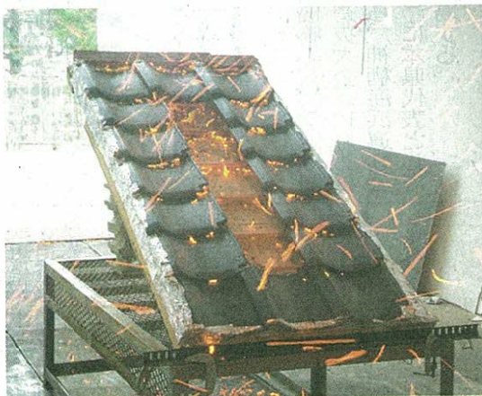
実験成果の一例として、想定外の大地震で屋根瓦がずれたりすると、火の粉が野地板に落下し火災を引き起こす可能性があることが実証されました
