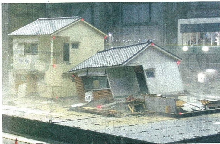
2棟の家の振動実験結果。無補強の右の家は倒壊したが、耐震補強を施した左の家は倒壊を免れた(2005年11月文部科学省「大都市大震災軽減化特別プロジェクト」による実験)
