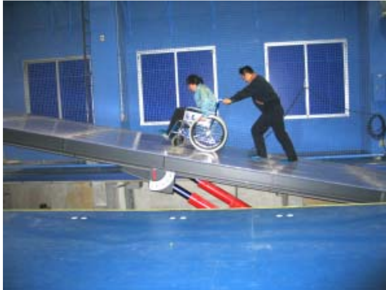
実験棟施設の例：勾配可変スロープ
