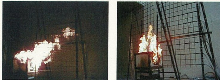
図3 強風下の火炎形状(参考に無風下の様子を右図に示す)
