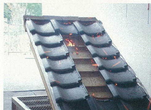
図7 実際に着火に至った様子 着床火の粉は風の影響で瓦棧のあたりに集積し、着火に至る。
