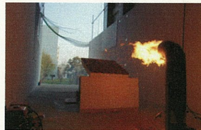
図5 日米共同実験の様子 (屋根の一部を火の粉シャワーに曝露)
