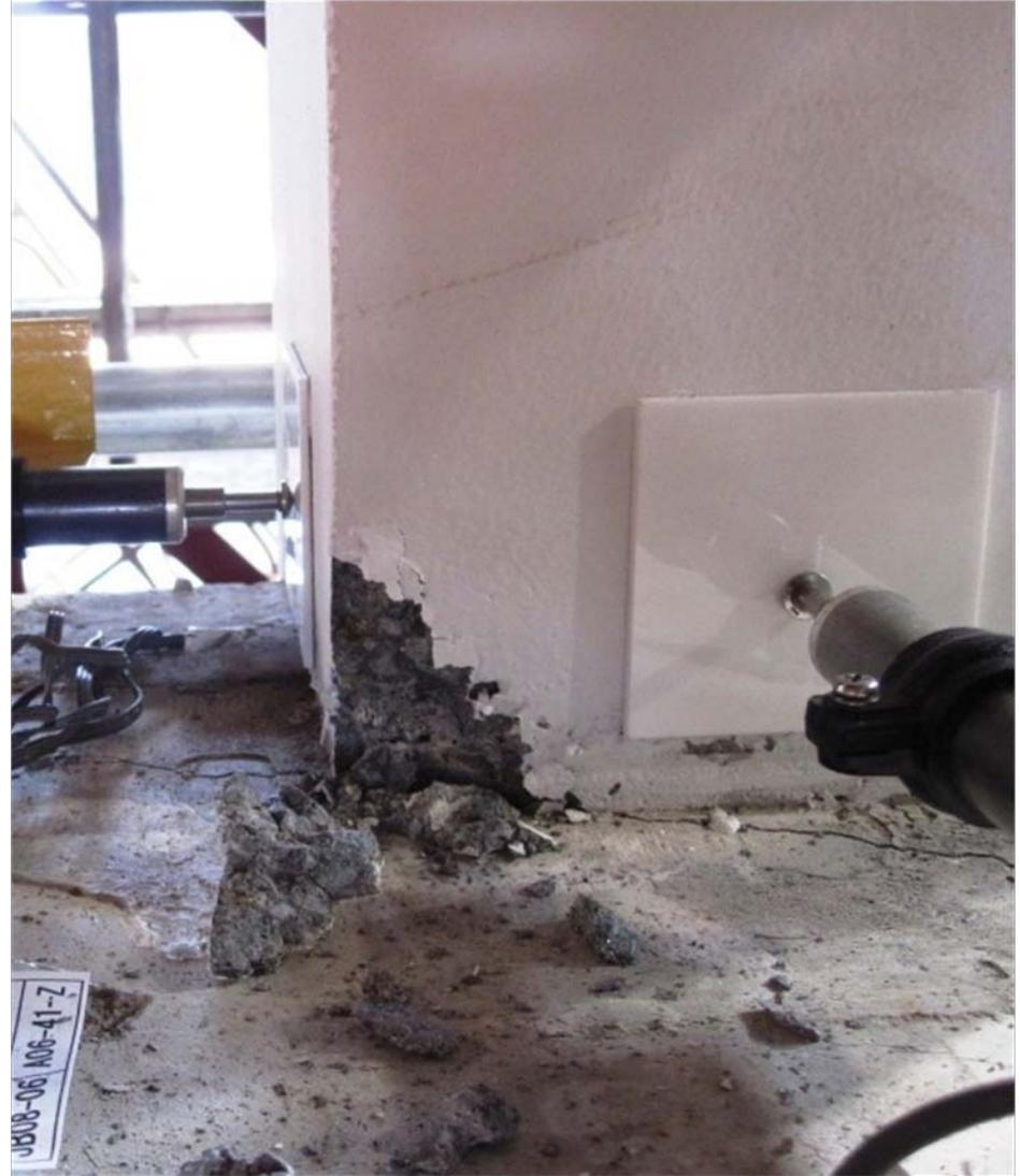
柱脚部の曲げ圧壊
