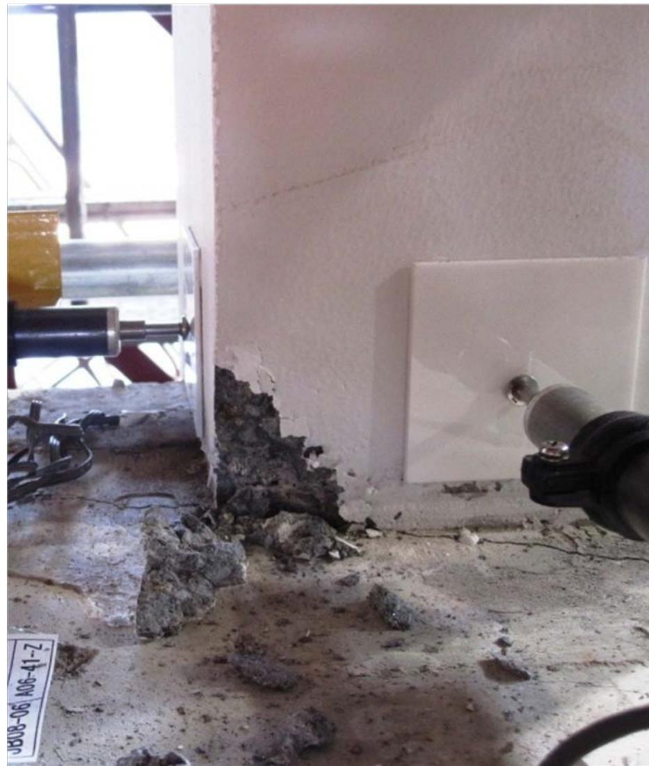
柱脚部の曲げ圧壊
