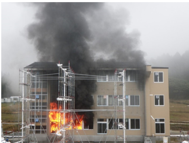
【写真1】出火室フラッシュオーバー (*再着火から48分後)
