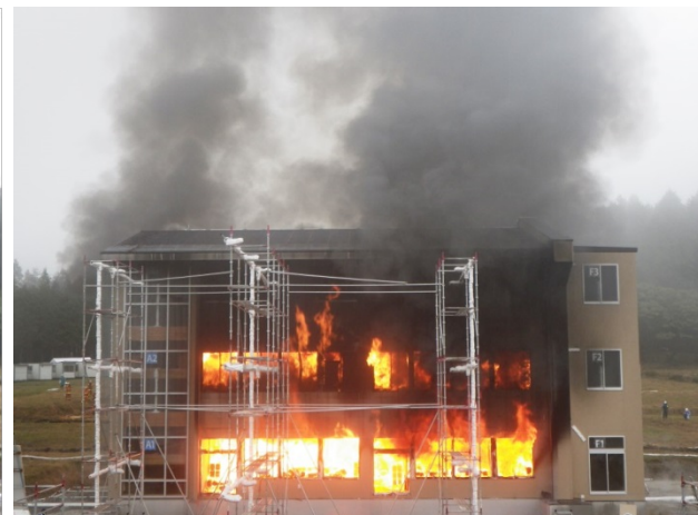
【写真3】3階教室に延焼 (*再着火から67分後) *経過時刻は精査の結果見直すことがあります。
