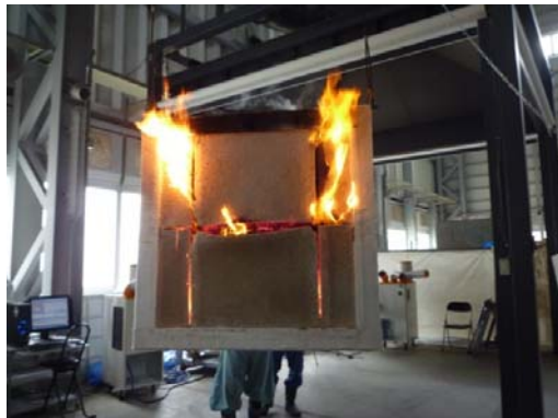
部材の耐火試験
