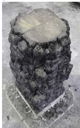
加熱を受けた柱の断面
