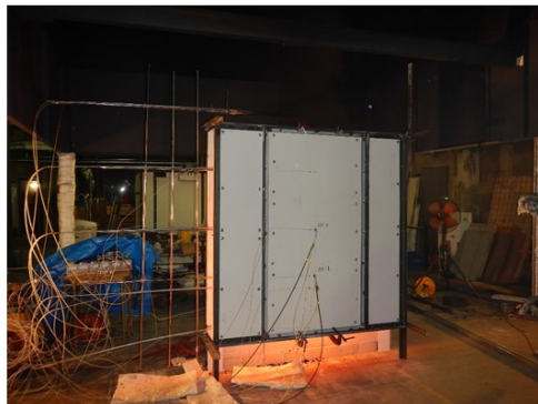
中空層の厚さによる火炎高さの変化
