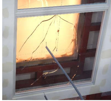
32分後: アウタースキンのガラスに亀裂
