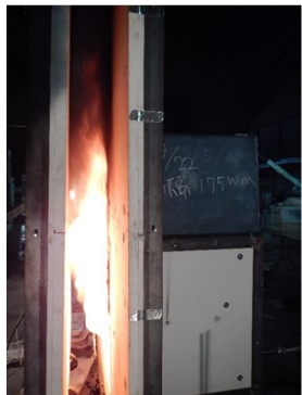
中空層の厚さによる火炎高さの変化
