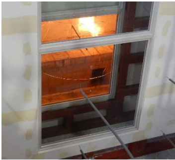
2分30秒後: インナースキンのガラスに亀裂
