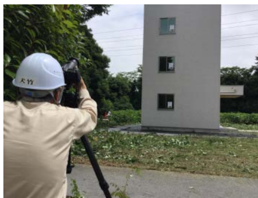
②地上撮影点検(カメラ)
