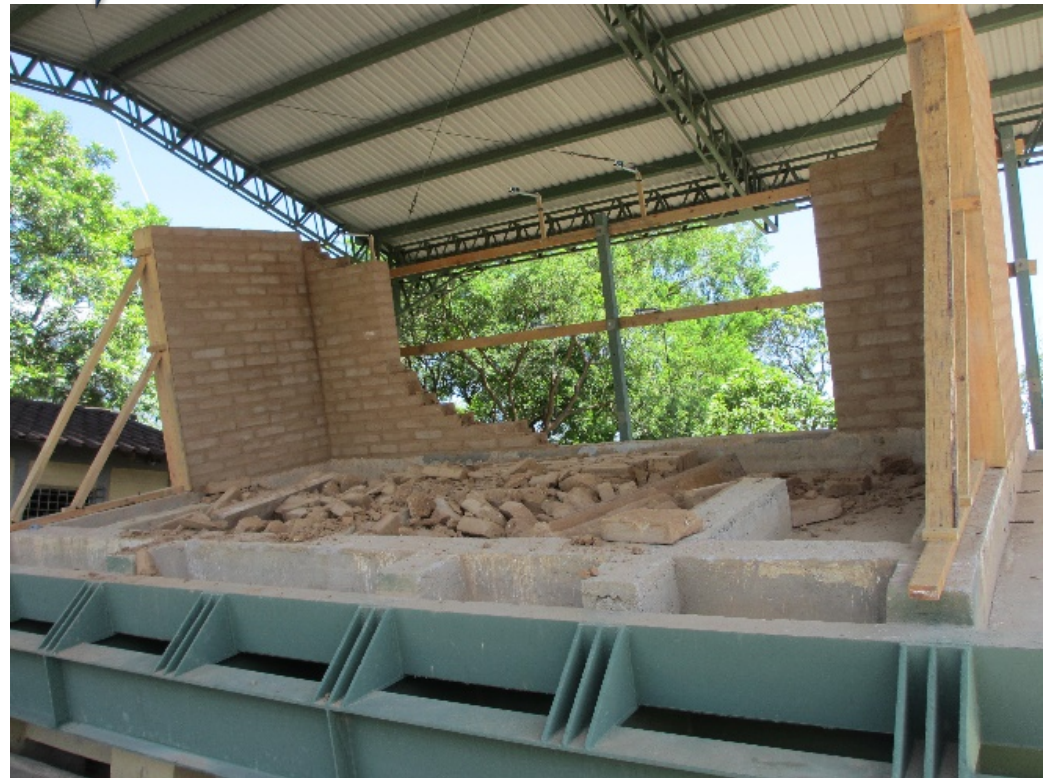
H29 エルサルバドルでの在外研修 (傾斜台での組積造構造実験)
