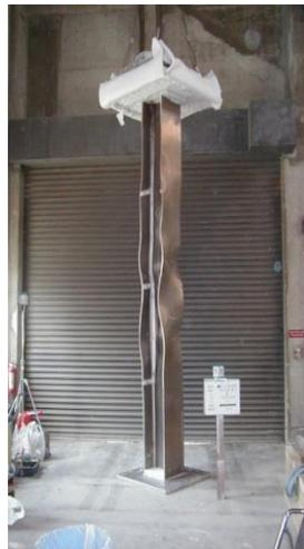
柱加熱炉で加熱後の柱
