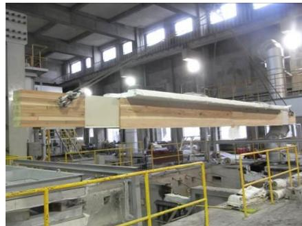
水平加熱炉で加熱前の梁試験体
