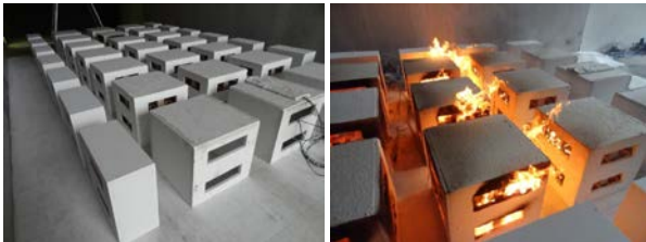
写真 1 市街地模型火災実験
