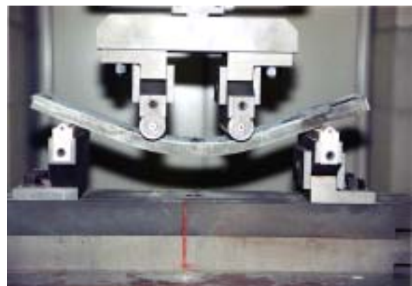
図-1 高靱性コンクリートの曲げ試験状況
