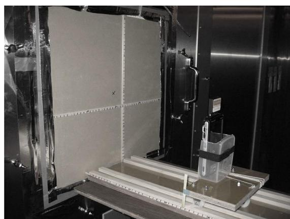
写真4 ICタグの読み書き性能を確認するための試験
