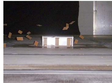
写真3 建築物模型の周囲を飛来する飛来物モデル
