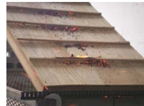
図 7 焼損 (3m/s) 図 8 集積した火の粉からの着火 (6m/s)
