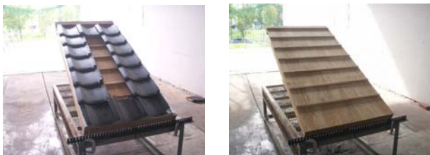
(1) 5枚脱落 (2) 全脱落 (21枚脱落)
