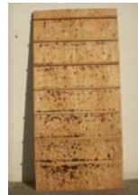
図 7 焼損 (3m/s) 図 8 集積した火の粉からの着火 (6m/s)
