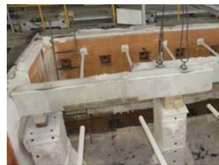
写真 2 2 時間耐火試験後の梁補修部の状況
