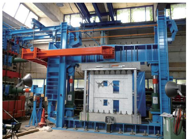
写真8 開口を有する耐力壁の実験
