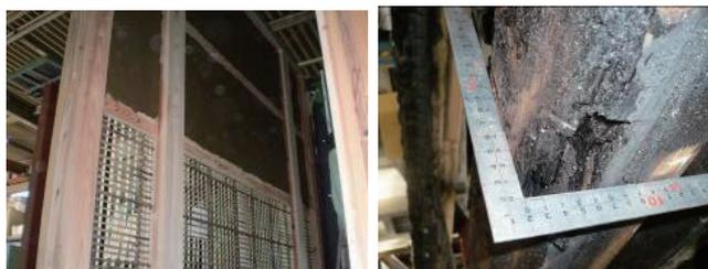
写真7 土塗り真壁造外壁準耐火構造仕様の開発
