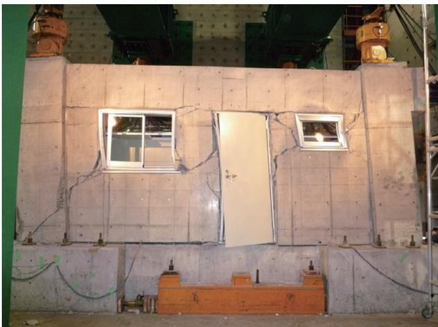
写真5 実大構造実験による被害の様子
