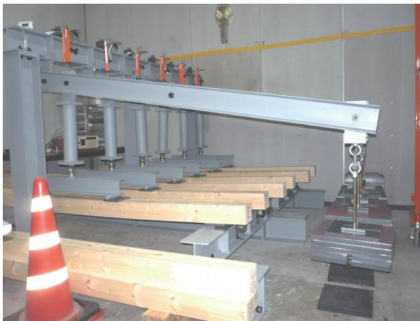
写真 9 クリープ破壊に関する実験
