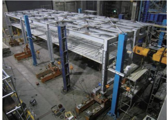
写真6 天井振動実験の様子
