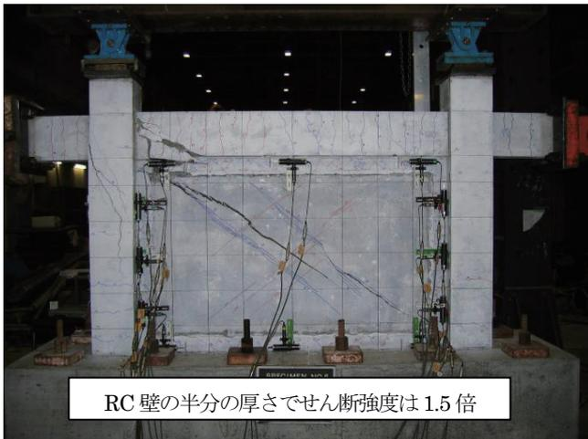
写真4 超高強度材料による補強の例 (UFC耐震壁)
