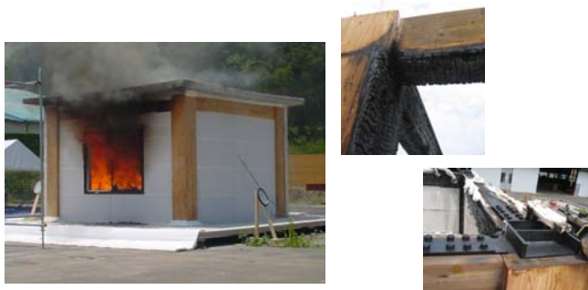
図7 実大火災実験の様子と部材の燃え止まりの状況
