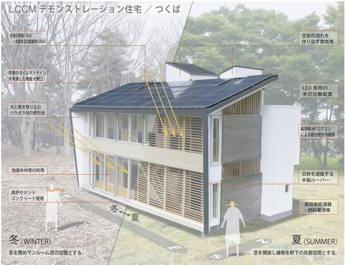
図 27 LCCM 住宅デモンストレーション棟の概要
