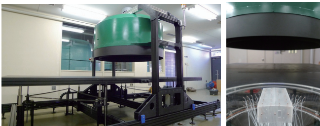
図2 竜巻発生装置の概観と建築物模型の設置状況
