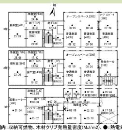
[]内:収納可燃物、木材クリブ発熱量密度(MJ/m2)、●:熱電対位置(床上1.8mから天井下面まで3~4本)、図中時間(分:秒): 450℃を超えた時間(450℃は、目視観察やビデオ記録と併せ、延焼判断の基になる)
