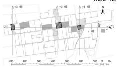
x軸上の降積密度は、原点から200~300m付近までは急激に減少。指数分布曲線形。実験中、数箇所で飛火(草地の焦げ)。最遠の450m付近の降積密度は0.15~0.2g/m2程度。y1~y3軸上では、原点付近をピークとする山形の分布。原点付近を外れると急激に減少。その傾向は火源に近いほど顕著。
