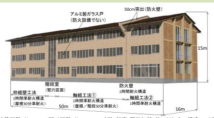
建築面積:約830m2、延べ面積:約2260m2、外壁・軒裏・間仕切壁・柱・はり・床の構造: 1時間準耐火構造、屋根・階段の構造:30分準耐火構造、壁・天井・床の仕上げ:木材(枠組壁工法1階、軸組工法1階)、石膏ボード(枠組壁工法2,3階)、石膏ボード(軸組工法2,3階の壁)、木材(軸組工法2,3階の天井と床)、使用木材量:カラマツなど約200m3(枠組壁工法)、カラマツやスギなど約350m3(軸組工法)、その他約130m3の木材
