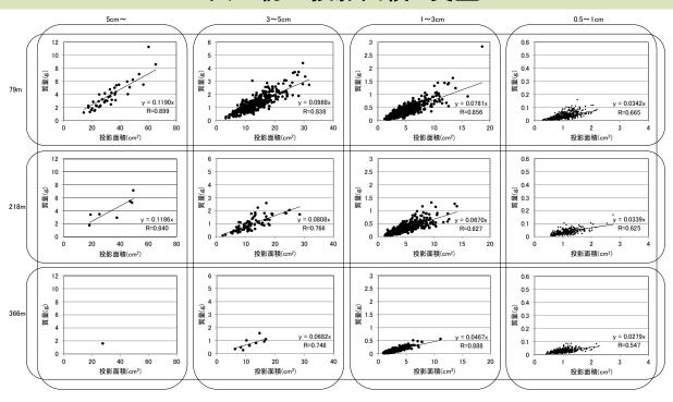
同程度の大きさの火の粉を比較すると、近似直線の傾きは飛距離と負に相関する。遠方に飛散する火の粉は厚さが薄いか、密度が小さいといえる。収集箇所が同じ火の粉を比較すると、小さい火の粉は厚さが薄いか、密度が小さい。
