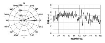
風向は東北東〜東、平均風速は4.6m/s(標準偏差は0.9m/s)。火災の進展に伴い発生した火の粉は風下の広範囲に飛散、降積。最長1655m。降積分布は火源を中心とする中心角約44°の扇形内。
