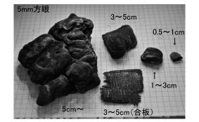
火の粉は、概して、大きさは様々で、膨らみがあり、体積の割には軽量。ただし、合板由来の火の粉は、繊維方向が直交して重なり合った状態を維持しており、薄いが、重量がある。(218m付近の3~5cm程度の火の粉全88個の内、合板に由来するものは8個。乾燥質量合計10.3g、全体の12.3%。投影面積合計94.9cm2、全体の9.2%)
