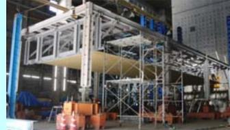
写真4 大規模加振実験
