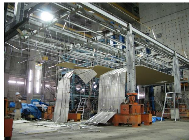
天井面の落下(大規模実験)
