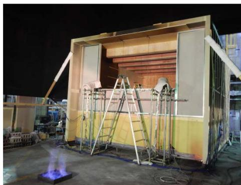
建築研究所実大火災実験棟に設置した試験体
