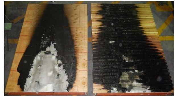
燃焼実験後の試験体表面
