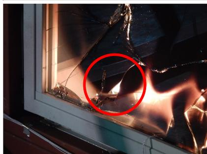
ガラス脱落時のLow-E複層ガラス(大試験体)
