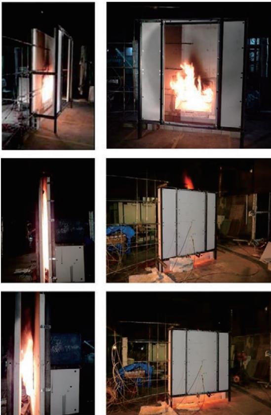
図9 模型実験による中空層の厚さによる火炎高さの変化 (上段: アウトースキン無し、中段: 実大スケールで 0.4m 相当、下段: 実大スケールで 1.8m 相当)
