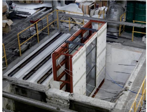
図6 建築研究所耐火炉に設置したダブルスキン実験装置
