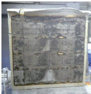
(2)加熱後の試験体 (2層めの被覆) の様子
