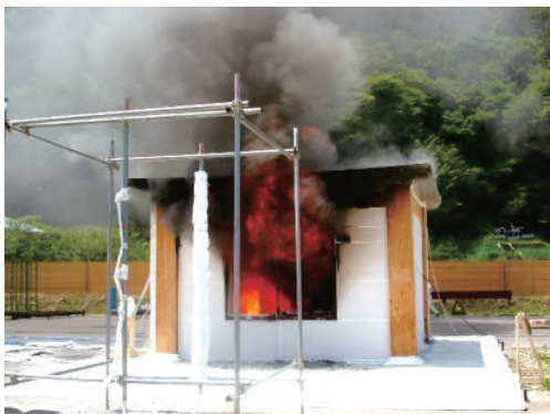
写真6 実大火災実験の様子
