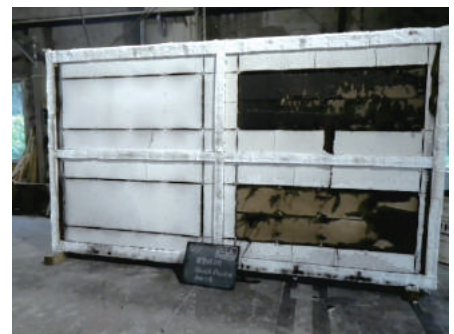
(3)試験体加熱面の加熱後の様子
