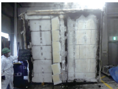
(2)加熱後の試験体の様子
