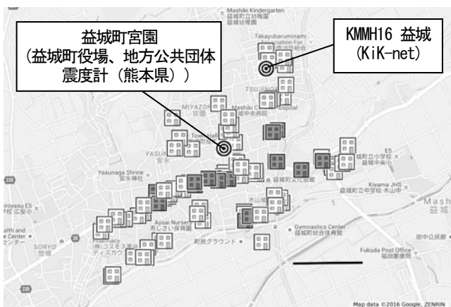
図 2-8 調査地域及び建築物位置（濃色は倒壊・大破を示す）
