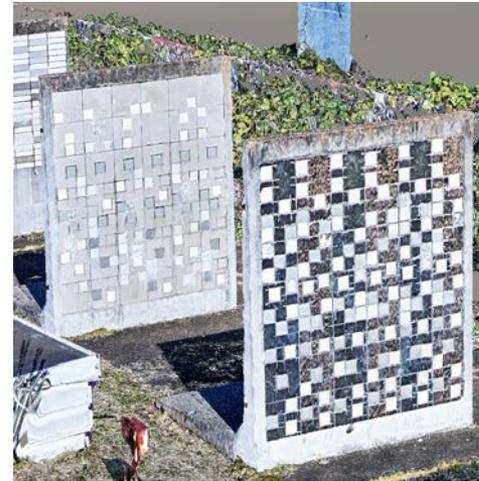
タイルの接着引張試験状況
