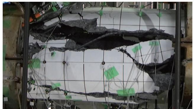
(a) 軸方向ひび割れを伴う破壊試験体
