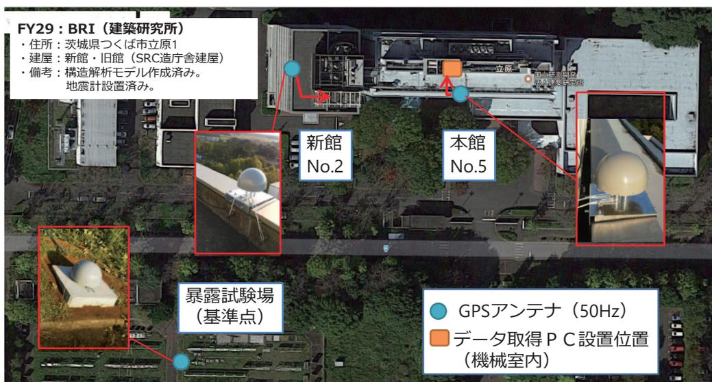
図3 建築研究所に配置したアンテナ及び受信機の位置
